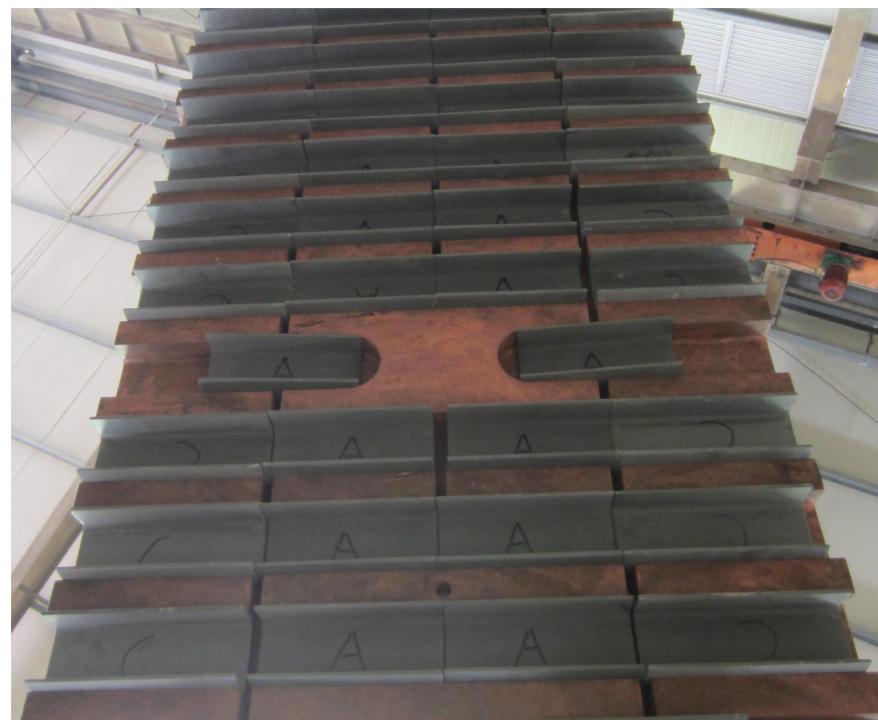
第4种：在燕尾槽内 预装折弯成型的燕尾形状钢块 ，并用耐火泥浆结合
