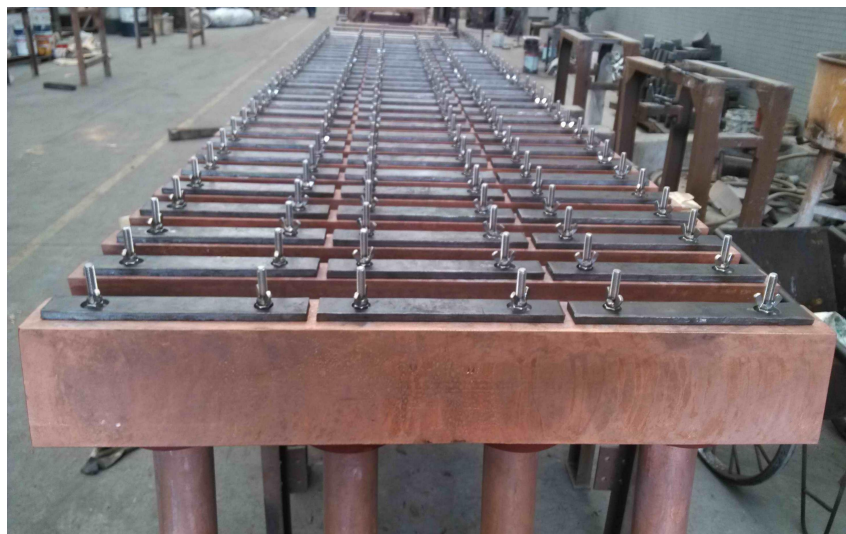
第3种：在槽肋同时 安装耐磨钢板和抓钉 ， 兼顾两者优点
