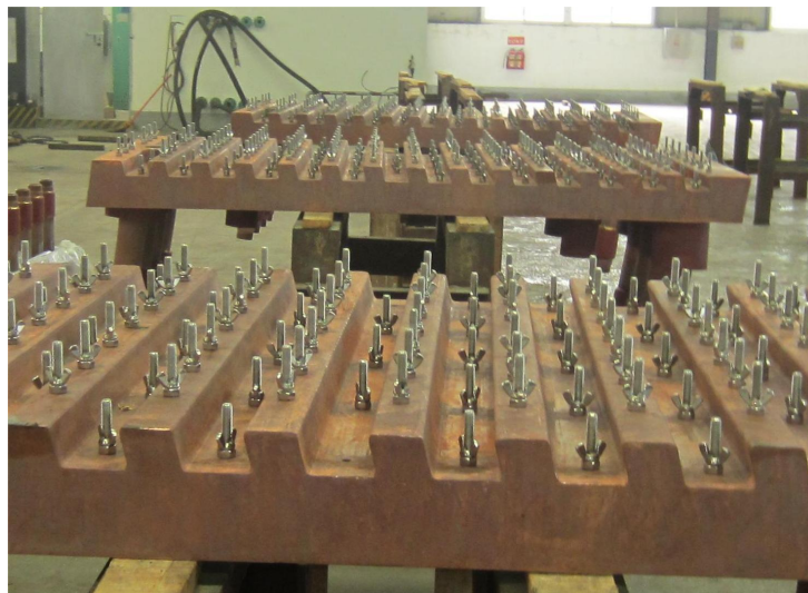
第2种：在燕尾槽的槽肋或槽底 安装抓钉 ，强化挂渣，避免渣皮频繁脱落
