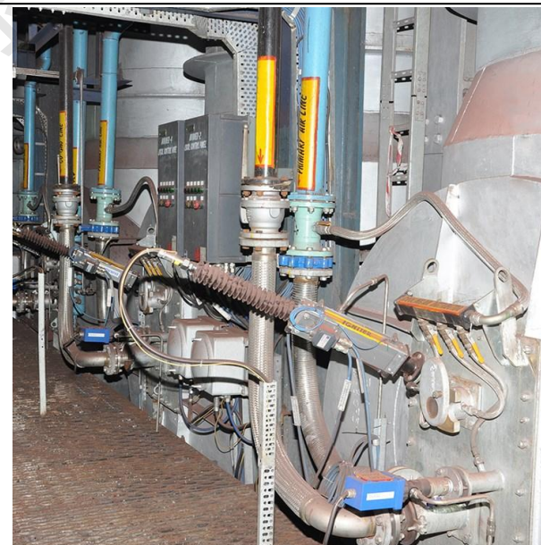
带式机现场安装的双燃料烧嘴
