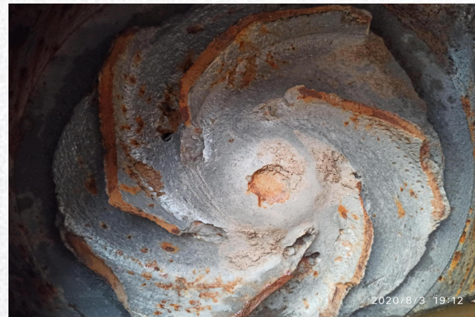
脱硫泵叶轮磨损
