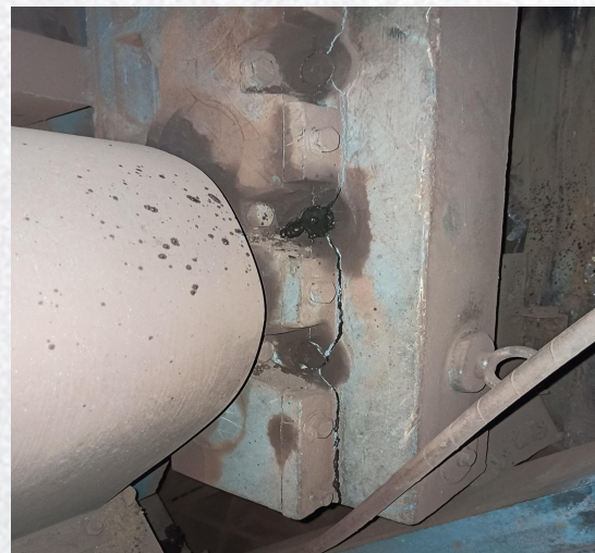
布料器减速机开裂
