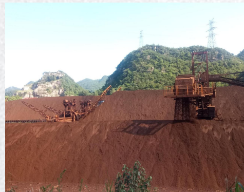
二次混匀料场三 台混匀取料机、 两台混匀堆料机
