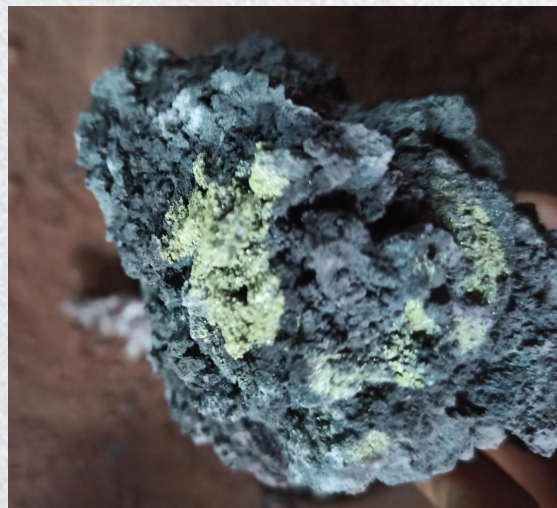
除尘器顶盖积水，灰仓板结严重
