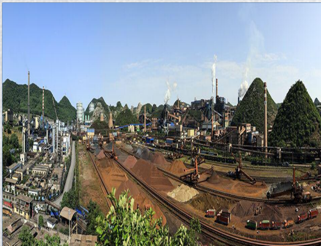
二次混匀料场三 台混匀取料机、 两台混匀堆料机
